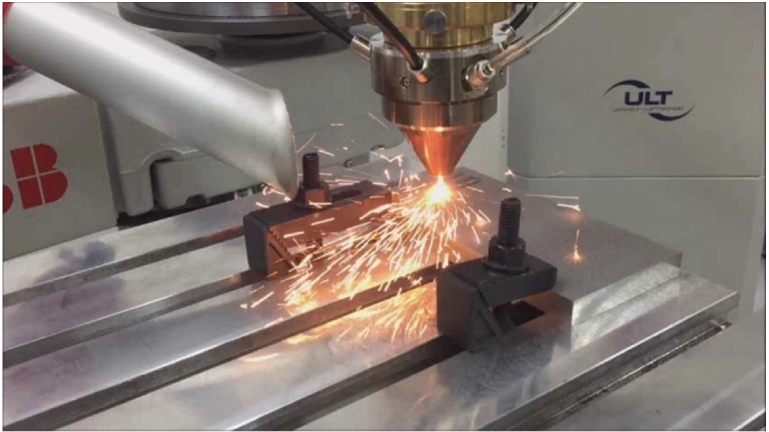
RUAG Australia erforscht mit dem Laser-Auftragschweissverfahren ein neues Reparaturverfahren für die Luftfahrt. © RUAG Australia
